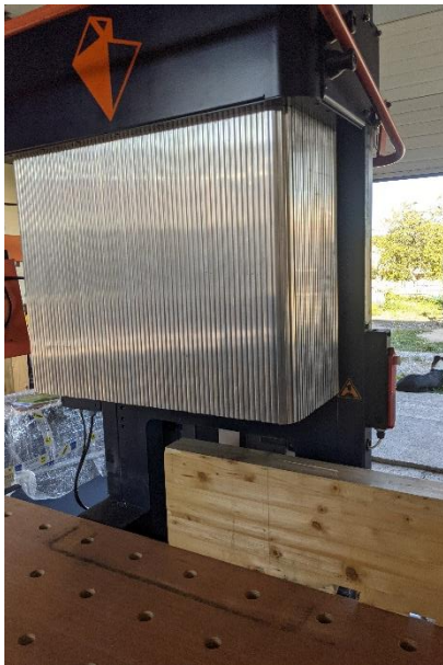
Dispositif de confinement de la zone d'usinage avant utilisation
